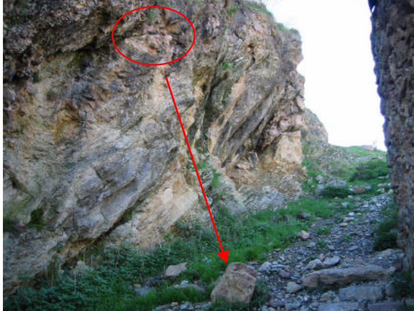
Fotografia 33: Talús rocós ( b indicat al plànol 11). El cercle indica la cicatriu de despreniment i la fletxa indica el bloc caigut.
