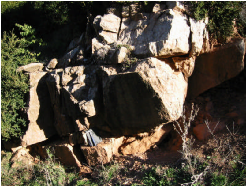
Fotografia 26: Talús rocós del marge d'un camí del vessant situat al sud del poble de Trejuvell. Observar que cabussa a favor del pendent.
