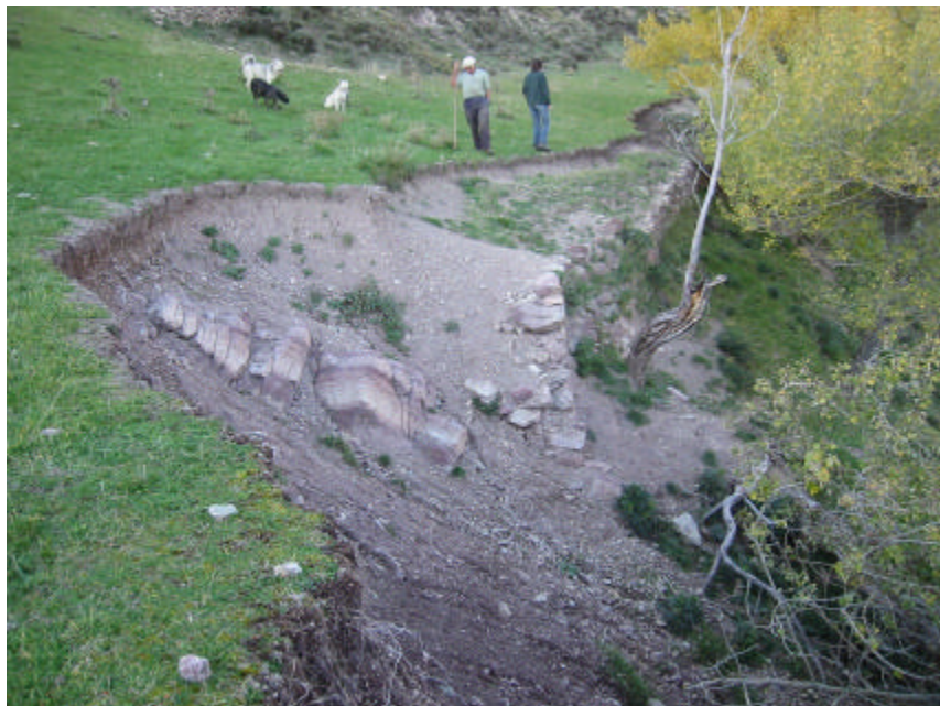
Fotografia 37: Exemple d'inestabilitat superficial, es tracta de diverses cicatrius semicirculars recents, ( c , plànol 12 )
